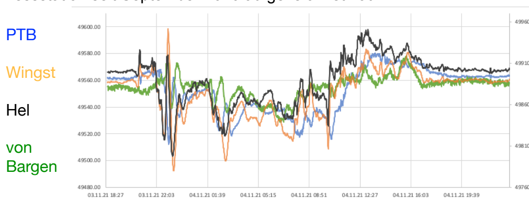
Diagramm 3: Magnetfeldmessdaten der Wingst, PTB, Hel und meiner Station im Vergleich, Zeitraum 3.11.21 18:35 - 4.11.21 23:00
